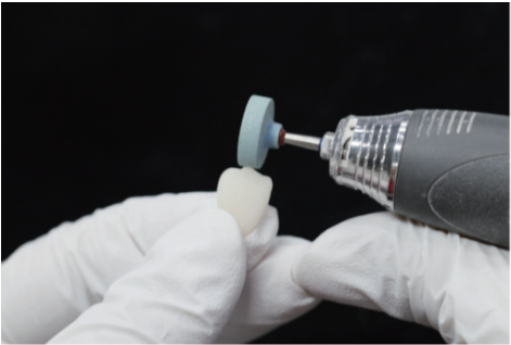
2. 将铸道连接点打磨平整
